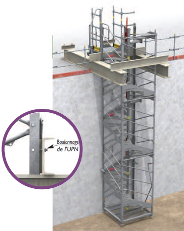
Schéma d'un Escalib MDS suspendu pour accéder au fond de fouille.
