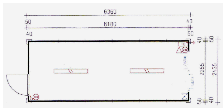
Pos de Plinthes: Equipement électrique dans cache-poteaux Trappe Climatiseur: Dimensions du climatiseur 450 x Ht 350 mm
