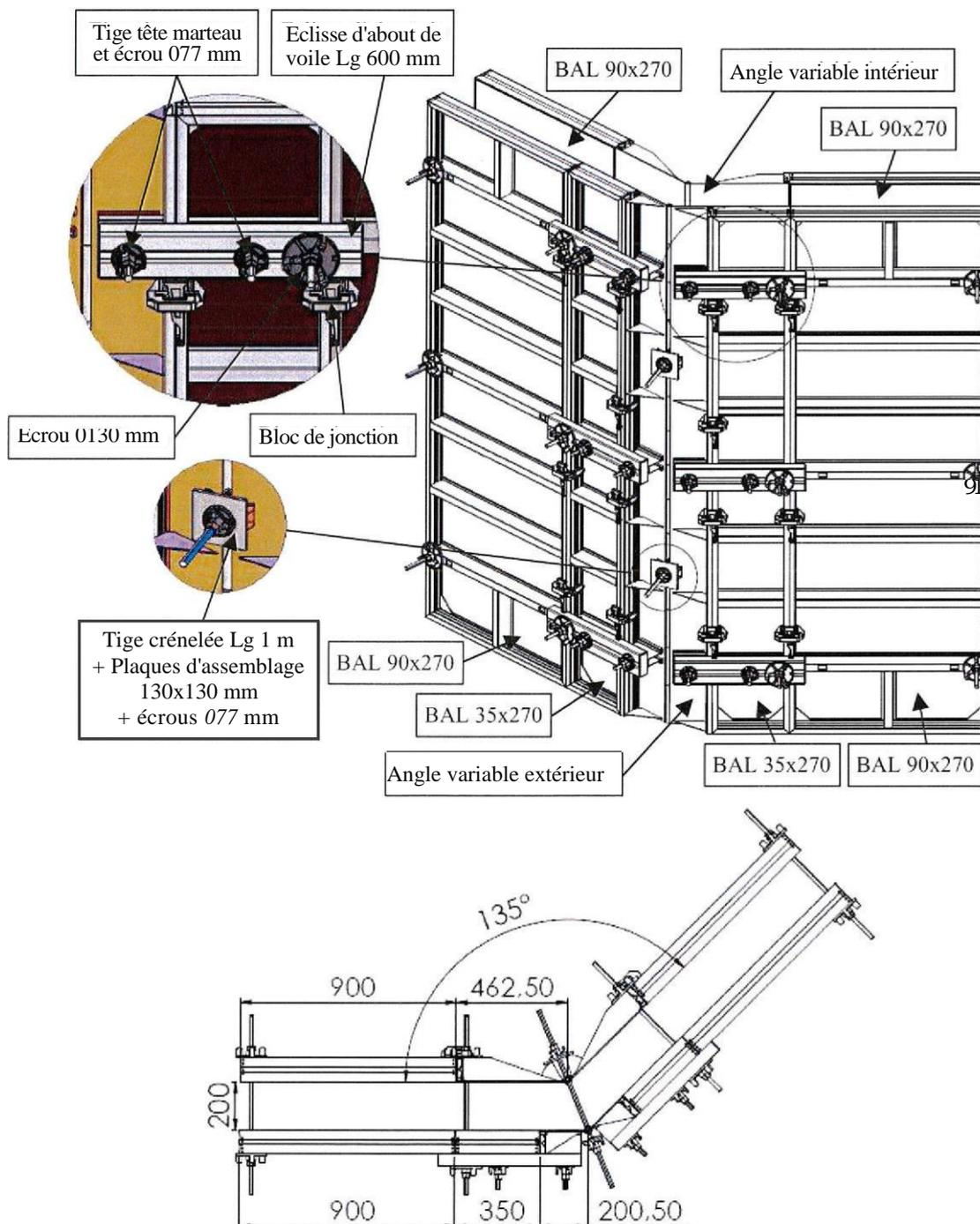
Dans le cas de l'angle variable de Ht 150 cm et 300 cm, procéder au montage de la même manière que l'angle variable de Ht 270 cm.
